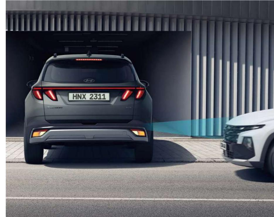
**Система предотвращения столкновения при движении задним ходом (RCA)**
