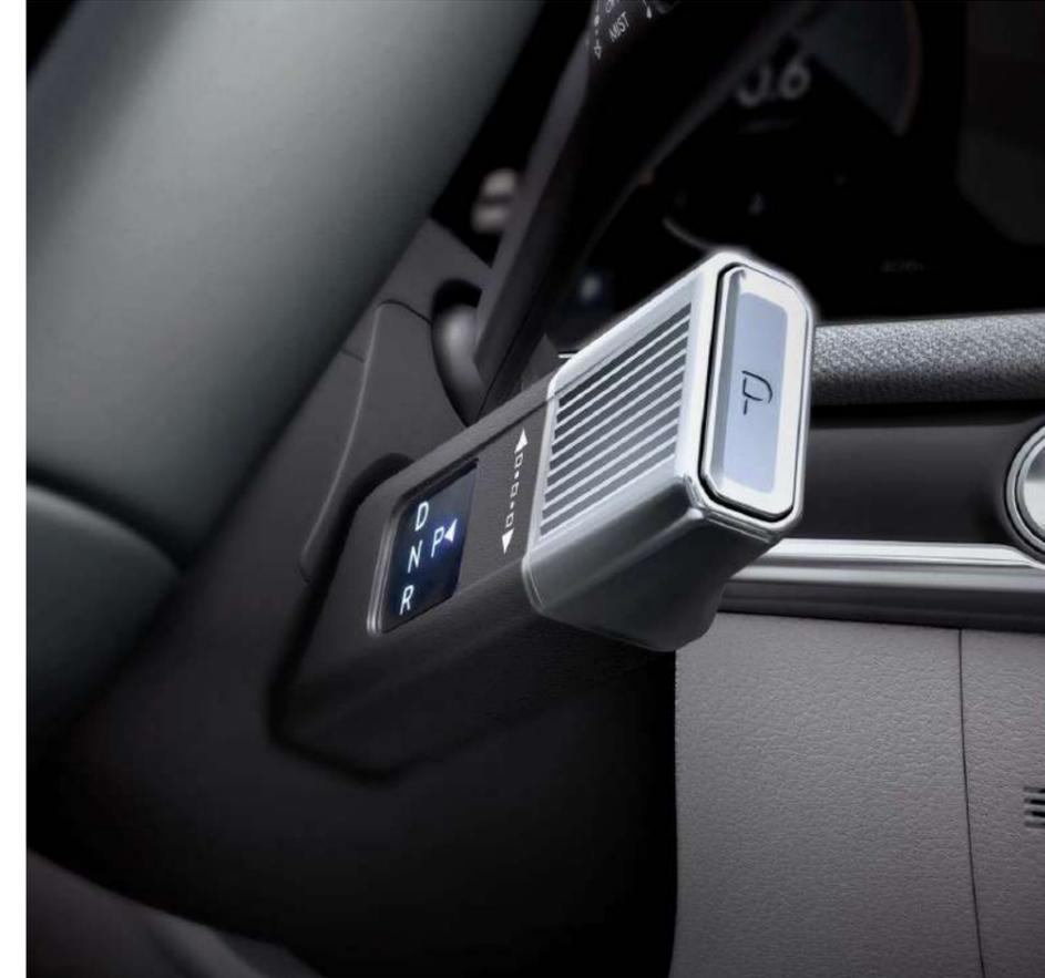
Рычаг селектора передач на рулевой колонке (SBW)
