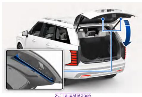
Опустите крышку багажника и нажмите на нее, пока она не зафиксируется. Всегда проверяйте, что крышка багажника надежно закрыта, снова потянув ее вверх, не нажимая кнопку на ручке багажника.
