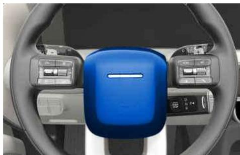
Чтобы подать звуковой сигнал, нажмите в том месте рулевого колеса, которое обозначено символом гудка (см. иллюстрацию). Звуковой сигнал сработает только при нажатии на эту область.
