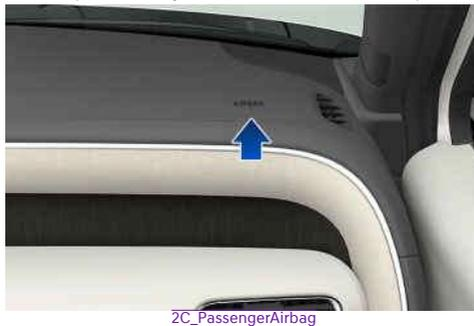
Система подушек безопасности состоит из подушек безопасности, установленных в центре рулевого колеса и в панели приборов со стороны пассажира (над бардачком).
