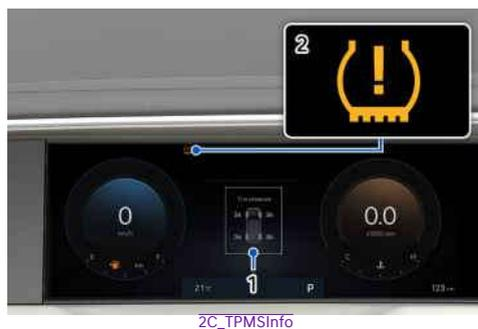
1. Указатель положения шины с низким давлением и давления в шинах (отображается на дисплее панели приборов)
