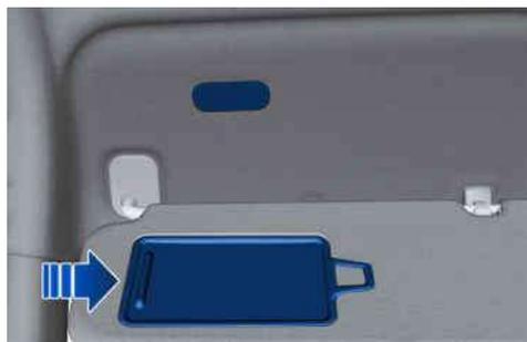
Открывание крышки зеркала. Лампа подсветки зеркала в солнцезащитном козырьке включается, когда крышка открыта, и выключается, когда крышка закрыта.
