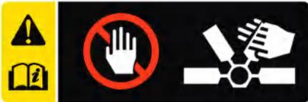
Когда двигатель не работает, электродвигатель вентилятора охлаждения двигателя может продолжать работать или включаться. Это может привести к серьезным травмам. Держите руки, одежду и инструменты подальше от вращающихся лопастей вентилятора охлаждения.
