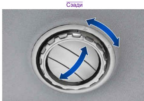
С помощью рычага регулировки вентиляции поток воздуха в вентиляционных отверстиях панели приборов может быть направлен вверх/вниз или влево/вправо. Дефлекторы можно открывать или закрывать по отдельности рычагом управления дефлектором.
