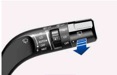
В положении **OFF (O)** слегка потяните рычаг на себя, чтобы подать омывающую жидкость на лобовое стекло и запустить стеклоочистители на 1–3 цикла. Разбрызгивание и работа стеклоочистителя будут продолжаться, пока вы не отпустите рычаг. Работа стеклоомывателя и стеклоочистителя будет продолжаться до тех пор, пока вы не отпустите рычаг. Если стеклоомыватель не работает, возможно, необходимо пополнить количество моющей жидкости в бачке стеклоомывателя.
